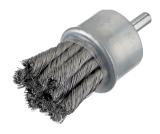
Applications : Cardage, ébavurage, enlèvement de laque et scories, détartrage, dépolissage, nettoyage.
