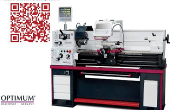
Puissance moteur:  $1.5 \, \text{kW} / 400 \, \text{V} / 3 \, \text{Ph} \sim 50 \, \text{Hz}$ Hauteur de pointes : 205 mm Entrepointes: 1000 mm Capacité de la tourelle : max. 16 mm Diamètre max. sous le banc rompu : 540 mm Longueur du banc rompu: 165 mm Largeur de banc : 206 mm Vitesse de broche : 45 - 1800 T/min. Plage de vitesses : 16 plages Cône Morse de broche: CM 6 Diamètre du fourreau : Ø 45 mm
