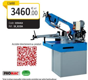
Scie à ruban manuelle à descente assistée par vérin hydraulique Capacité de coupe 90° rond/carré/rectangle : 225/200x200/240x160 mm Capacité de coupe 45°D rond/carré/rectangle:150/140x140/210x140 mm Capacité de coupe 60°D rond/carré: 90/902x90 mm Tension(V): 400
